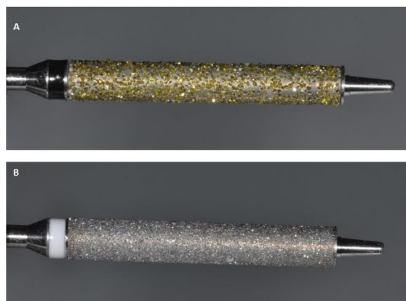
Fig. 3. A): medium-grit burs; B): fine-grit burs.
